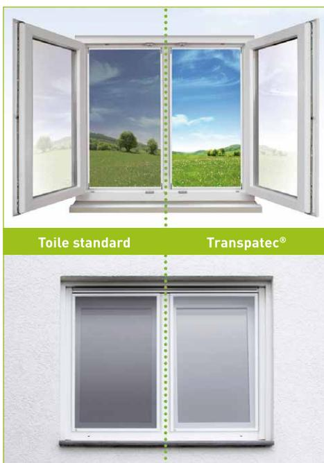
Constituée de fils ultrafins ( $\varnothing$  0,13 mm), la toile Transpatec® résulte d'une technique de tissage innovante qui lui confère une homogénéité exceptionnelle. Son maillage spécifique la rend très résistante aux intempéries et à la déchirure (testée et confirmée par un laboratoire de contrôle indépendant conformément à la norme DIN EN ISO 13934-1) pour une durabilité exceptionnelle.
