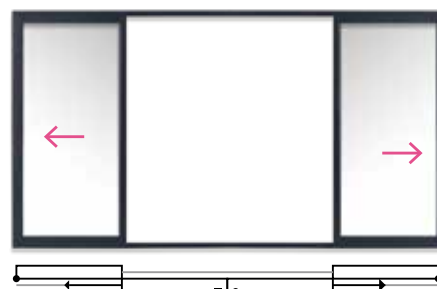
4 vantaux - 2 rails Largeur jusqu'à 6,20 m
