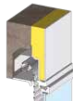
Volet roulant 1/2 linteau incorporé à la menuiserie
